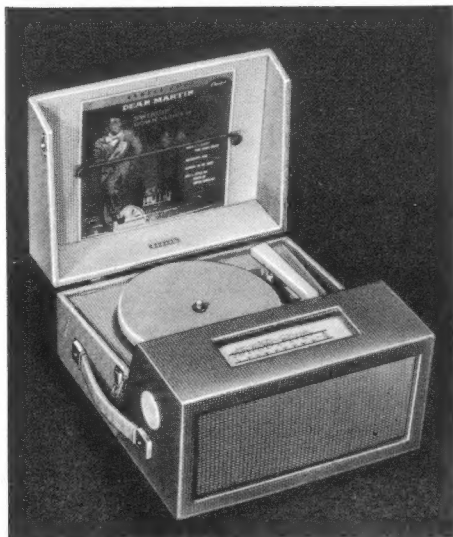
Bild 10. Tragbarer Plattenspieler mit Rundfunkteil in gemischter Bestückung (Hf- und Zf-Teil mit Röhren, Nf-Teil mit Transistoren; Gossor)
