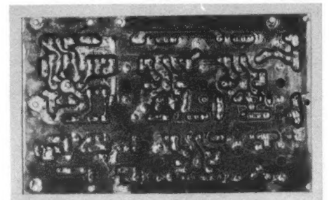
Bild 7. Zf-Verstärker eines PAM-Fernsehempfängers mit gedruckter Schaltung; die gute Übersichtlichkeit der Einzelteile erleichtert die Reparatur (Chassis und Blick auf die Unterseite)
