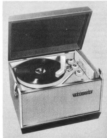
Bild 6. Plattenspieler mit batteriegespeistem Motor für Kleinplatten mit 45 U/min, Verstärker mit vier Transistoren. Ein Batteriesatz reicht für 1500 Plattenseiten; Anschluß für Mikrophon (Philco)
