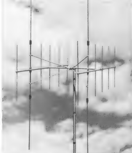
Bild 12. Kombinationsantenne für Band I und III, Type Doppel-Delta mit phasenkorrigierten Dipolen (Telerection)
