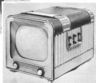
Bild 2. Beispiel 2 des neuen englischen Gehäusestils: 43-cm-Fernsehempfänger mit vertikal angeordnetem Chassis, aluminisierter Bildröhre und abschraubbaren Beinen (Ferguson Modell 306 T)
